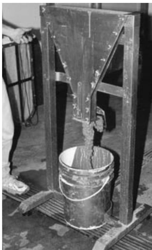
Figura 4. Ensayo con embudo en V
